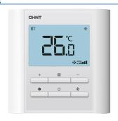
TFP210L是我司自主研发的一体式联网型风机盘管温控器,它集房间温控校正系数设定,环境温度设定,风机盘管运行方式设定以及时间计量功能于一身,通过采集高精度传感器信号与设定温度进行比较,根据设定的工作方式,输出控制信号,自动控制电动阀和风机,达到保持室内恒温的目的,适用于四管制的末端空调系统。具有LORA通讯接口,配合LORA网关可实现空调远程管理和计量计费等功能。
